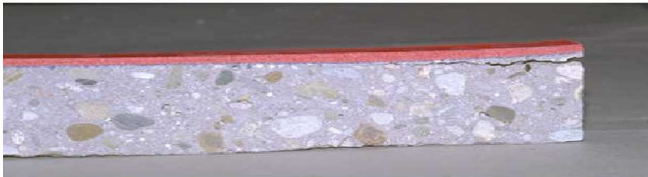
Obr.1. Prasklina, kterou přivodila cyklická změna teplot epoxidové malty aplikované na nepružném primeru.
